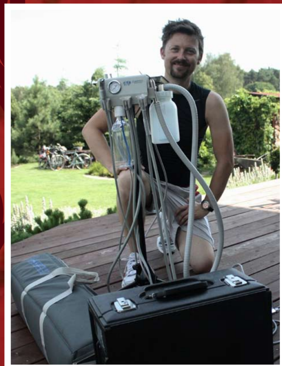
Dr Bartosz Niedziółka prezentujący przenośny unit stomatologiczny. Sprzęt jest nowy, lekki, łatwy w obsłudze i mało awaryjny. Wykorzystywany jest przez armię w warunkach polowych. Cały komplet waży około 25 kg
